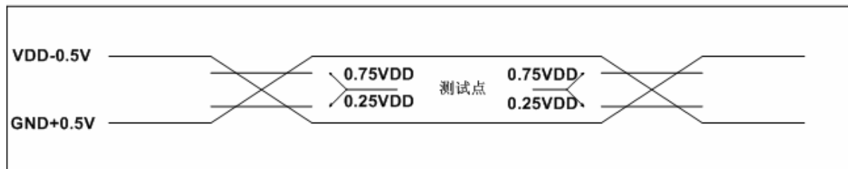
AC 测试输入/输出波形
