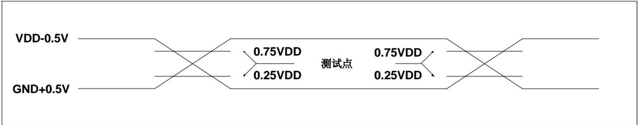
交流测试：输入在被VDD-0.5V驱动时为逻辑“1”，在GND+0.5V时为逻辑“0”。时序测量是以0.75VDD代表逻辑“1”，0.25VDD代表逻辑“0”。
